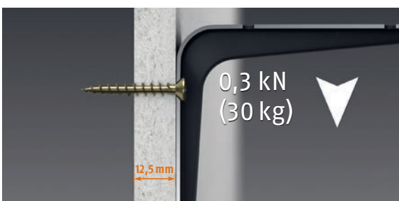
Direkt in die Platte geschraubt, hält die Befestigung immer noch bis 30 Kilogramm.
