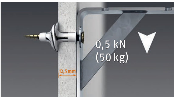
... mit einem Hohlraumdübel hält eine Schraube bis zu 50 Kilogramm.
